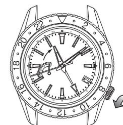
Rodando a coroa no sentido inverso aos ponteiros do relógio (na direção das 6 horas): o ponteiro das horas avança uma hora.
