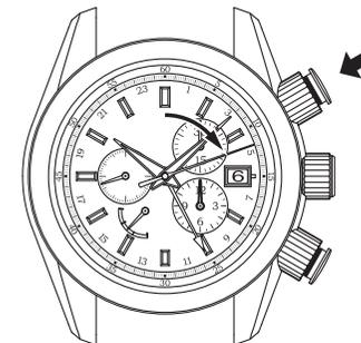
④ Interrompa a medição do tempo. No momento em que quiser terminar a medição, prima novamente o botão START/STOP para parar os ponteiros do cronógrafo.
