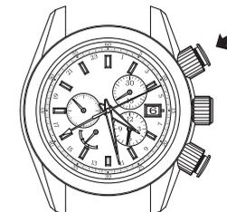
⑤ Reponha os ponteiros do cronógrafo. Depois de parar os ponteiros do cronógrafo, prima o botão RESET para repor todos os ponteiros do cronógrafo na posição 0.
