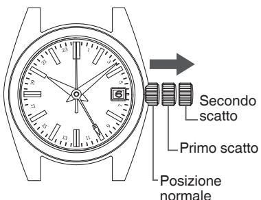
② Ruotare la corona in senso antiorario (direzione verso le ore 6) per ruotare la lancetta delle 24 ore e dei minuti in senso orario e impostarle sull'ora corrente.
