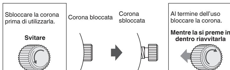
\* Durante il bloccaggio della corona, ruotarla lentamente con attenzione, assicurandosi che la vite sia correttamente innestata. Prestare attenzione a non spingerla con forza, in quanto ciò potrebbe danneggiare il foro della vite nella cassa.
