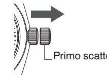
② Ogni volta che, agendo sulla corona, si fanno fare due complete rotazioni alla lancetta delle ore la data cambia di un giorno. Ruotando la corona, il momento in cui la data cambia è la mezzanotte (ore 24). Predisponendo la lancetta delle ore verificare che le ore, antimeridiane o pomeridiane, siano state predisposte in modo corretto.
