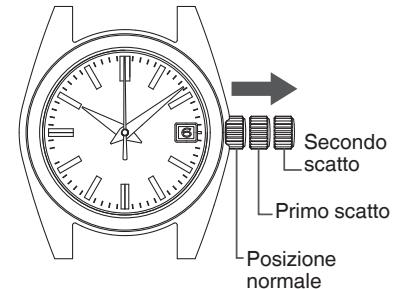
② Girare la corona in senso antiorario (in direzione delle ore 6) per ruotare l'ago, quindi impostare l'ora facendo attenzione alla lancetta dei minuti. In relazione al meccanismo degli orologi al quarzo, per una accurata predisposizione dell'ora portare la lancetta dei minuti di 4 o 5 minuti oltre il punto desiderato, e farla poi retrocedere sino all'esatto minuto da predisporre.
