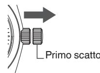
⑤ Ruotare la corona per predisporre la lancetta delle ore. Ruotando la corona la data cambia quando si oltrepassa la mezzanotte.
