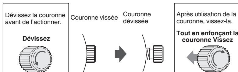
\* Lors du verrouillage de la couronne, tournez-la lentement et avec précaution en vous assurant que la vis est correctement engagée. Veillez à ne pas l'enfoncer avec force, car cela pourrait endommager les filetages.
