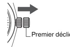
⑤ Tournez la couronne pour régler l'aiguille des heures. Pendant la rotation de la couronne, le moment du changement de la date est minuit. Lors du réglage de l'aiguille des heures, assurez-vous que le réglage matin/soir (AM/PM) est correct. Au besoin, réglez aussi la date à ce stade.
