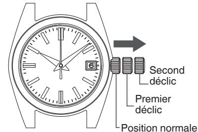
② Tourner la couronne dans le sens antihoraire (vers les 6 heures) pour faire tourner l'aiguille, ensuite réglez l'heure en tenant compte de l'aiguille des minutes. En raison du mécanisme des montres à quartz, pour ajuster l'heure avec exactitude, dépasser d'abord la minute souhaitée de 4 à 5 minutes, puis revenez en arrière à la minute exacte.
