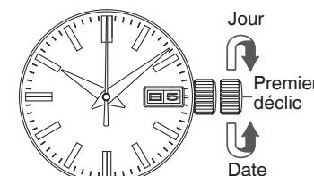
③ Tirez la couronne jusqu'au second déclic lorsque l'aiguille des secondes est positionnée sur 12 heures. L'aiguille des secondes s'arrête sur le point. Tournez la couronne dans le sens antihoraire (vers les 6 heures) pour avancer les aiguilles jusqu'à ce que la date désirée s'affiche.
