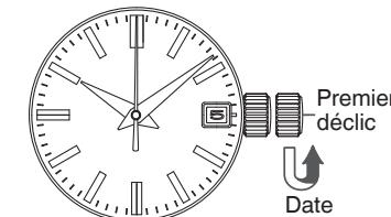
③ Tirez la couronne jusqu'au second déclic lorsque l'aiguille des secondes est positionnée sur 12 heures. L'aiguille des secondes s'arrête sur le point. Tournez la couronne dans le sens antihoraire (vers les 6 heures) pour avancer les aiguilles jusqu'à ce que la date désirée s'affiche.
