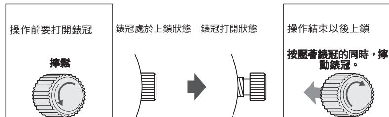
\* 鎖住錨冠時，輕輕轉動，注意螺絲的嚮合。注意不要用力按壓，這樣做可能會損壞錨殼上的螺絲孔。
