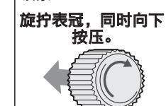
\* 锁紧表冠时，应慢慢旋拧，以确保螺丝正确啮合。注意不要过于用力按压，否则可能损坏表壳中的螺丝孔。
