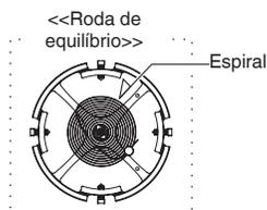
A temperatura faz com que os metais se expandam ou contraiam. Esta característica de todos os metais também se aplica à espiral. Isto afeta a precisão de um relógio mecânico.
