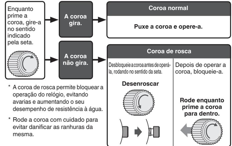
\* A coroa de rosca permite bloquear a operação do relógio, evitando avarias e aumentando o seu desempenho de resistência à água.
