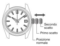
Nei modelli con corona del tipo con chiusura ad avvitamento, ricordarsi AVVERTENZA di avvitare e bloccare la corona.
