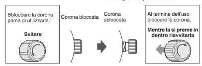
\* Durante il bloccaggio della corona, ruotarla lentamente con attenzione, assicurandosi che la vite sia correttamente innestata. Prestare attenzione a non spingerla con forza, in quanto ciò potrebbe danneggiare il foro della vite nella cassa.
