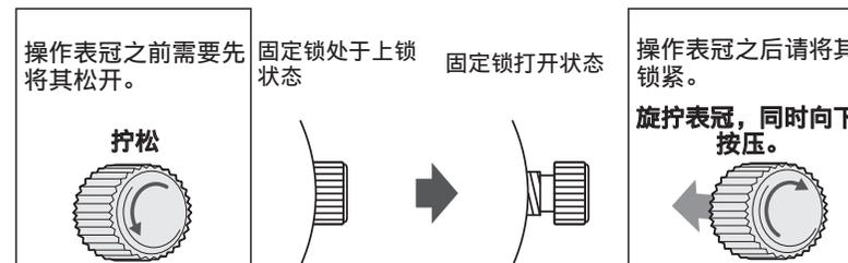
\* 锁紧表冠时, 应慢慢旋拧, 以确保螺丝正确啮合。注意不要过于用力按压, 否则可能损坏表壳中的螺丝孔。
