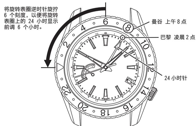
将旋转表圈逆时针旋转 6 个刻度，以便将旋转表圈上的 24 小时显示前调 6 个小时。
