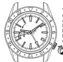
Tourner la couronne dans le sens horaire (vers les 12 heures) : l'aiguille des heures recule d'une heure.
