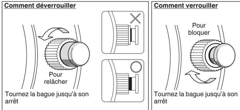
Tournez le bouton de sonnerie dans le sens antihoraire (vers 6h00) pour abaisser graduellement le couvercle coulissant. Continuez à tourner la bague de bouton jusqu'à ce que la ligne de repère soit clairement visible et que la bague de bouton ne puisse plus être tournée. Le bouton à vis
