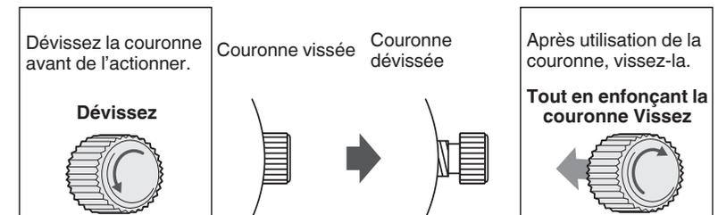
\* Lors du verrouillage de la couronne, tournez-la lentement et avec précaution en vous assurant que la vis est correctement engagée. Veillez à ne pas l'enfoncer avec force, car cela pourrait endommager le trou de la vis dans le boîtier.
