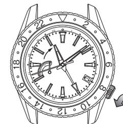
Drehen der Krone entgegen dem Uhrzeigersinn (Richtung 6 Uhr): Der Stundenzeiger wird um eine Stunde vorgestellt.
