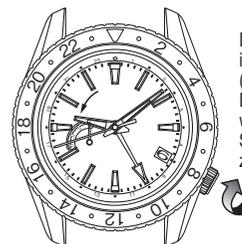
Drehen der Krone im Uhrzeigersinn (Richtung 12 Uhr): Der Stundenzeiger wird um eine Stunde zurückgestellt.
