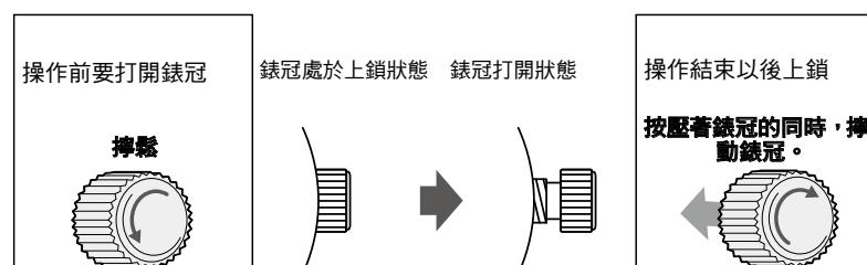
\* 鎖住錶冠時，輕輕轉動，注意螺絲的嚙合。注意不要用力按壓，這樣做可能會損壞錶殼上的螺絲孔。
