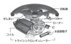
※上図は標準的なスプリングドライブの機構を図解したものになります。
