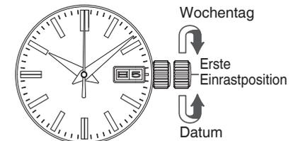
③ Ziehen Sie die Krone bis zur zweiten Einrastposition heraus, wenn der Sekundenzeiger auf der 12-Uhr-Position ist. Der Sekundenzeiger stoppt sofort. Drehen Sie die Krone entgegen dem Uhrzeigersinn (Richtung 6 Uhr), um die Zeiger weiterzudrehen, bis das gewünschte Datum angezeigt wird.
