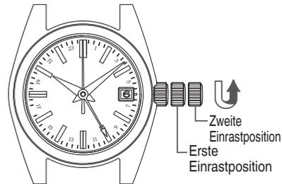
\* Stellen Sie zuerst nur den 24-Stundenzeiger und den Minutenzeiger ein. Auch wenn der Stundenzeiger nicht die richtige Zeit zeigt oder das Datum je nach der Position des Stundenzeigers noch geändert wird, ist es bei diesem Schritt noch nicht notwendig, diese einzustellen.
