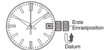
③ Ziehen Sie die Krone bis zum zweiten Einrastposition heraus, wenn sich der Sekundenzeiger in der 12-Uhr-Position befindet. Der Sekundenzeiger stoppt sofort. Drehen Sie die Krone entgegen dem Uhrzeigersinn (Richtung 6 Uhr), um die Zeiger weiterzudrehen, bis das gewünschte Datum angezeigt wird.
