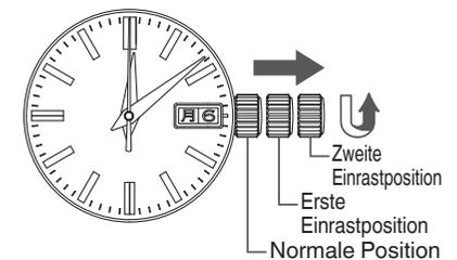
④ Wenn Sie den Stundenzeiger einstellen, achten Sie darauf, dass vor/nach Mittag richtig eingestellt wird, damit das Datum nicht mittags sondern gegen Mitternacht weiterrückt. Aufgrund des Mechanismus der Quarzuhr erzielen Sie die genaueste Zeiteinstellung, wenn Sie den Minutenzeiger zuerst 4 oder 5 Minuten vor die gewünschte Zeit und dann zurück auf die richtige Zeit drehen.
