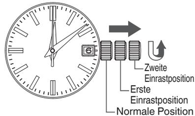
④ Wenn Sie den Stundenzeiger einstellen, achten Sie darauf, dass vor/nach Mittag richtig eingestellt wird, damit das Datum nicht mittags sondern gegen Mitternacht weiterrückt. Aufgrund des Mechanismus der Quarzuhr erzielen Sie die genaueste Zeiteinstellung, wenn Sie den Minutenzeiger zuerst 4 oder 5 Minuten vor die gewünschte Zeit und dann zurück auf die richtige Zeit drehen.
