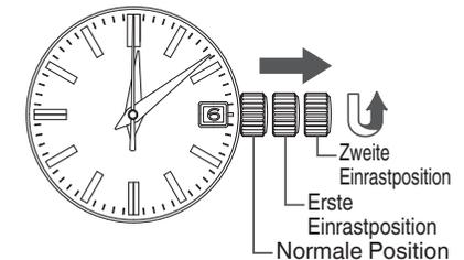
④ Wenn Sie den Stundenzeiger einstellen, achten Sie darauf, dass vor/nach Mittag richtig eingestellt wird, damit das Datum nicht mittags sondern gegen Mitternacht weiterrückt. Aufgrund des Mechanismus der Quarzuhr erzielen Sie die genaueste Zeiteinstellung, wenn Sie den Minutenzeiger zuerst 4 oder 5 Minuten vor die gewünschte Zeit und dann zurück auf die richtige Zeit drehen.
