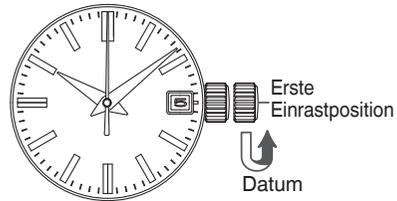
③ Ziehen Sie die Krone bis zum zweiten Einrastposition heraus, wenn sich der Sekundenzeiger in der 12-Uhr-Position befindet. Der Sekundenzeiger stoppt sofort. Drehen Sie die Krone entgegen dem Uhrzeigersinn (Richtung 6 Uhr), um die Zeiger weiterzudrehen, bis das gewünschte Datum angezeigt wird.
