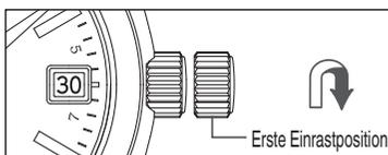
Die Krone im Uhrzeigersinn (in Richtung 12 Uhr) drehen:
