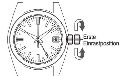
\* Die Krone kann in beide Richtungen gedreht werden, um das Datum einzustellen. Wir empfehlen jedoch, die Krone in die Richtung zu drehen, in der Sie die Einstellung mit geringerer Bewegung vornehmen können.
