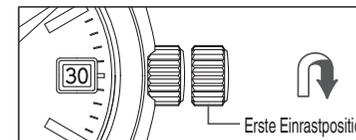
Die Krone im Uhrzeigersinn (in Richtung 12 Uhr) drehen:
