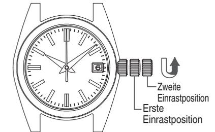
\* Möglicherweise ändert sich das Datum, je nachdem, ob der Stundenzeiger die falsche Uhrzeit anzeigt oder je nach Position des Stundenzeigers. Stellen Sie deswegen zunächst den Minutenzeiger ein.
