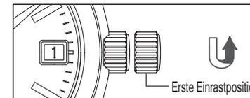
Die Krone entgegen dem Uhrzeigersinn (Richtung 6 Uhr) drehen:
